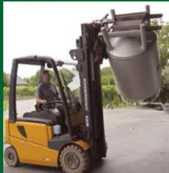
Поворачивание емкости с помощью вилочного погрузчика
